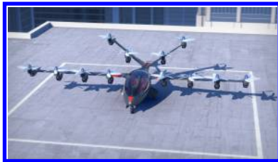
(d) An example tilt rotor: the Joby S2 [26].
